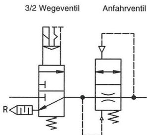
Belüftung der Anlage über Drosselstellung des Anfahrventils.
